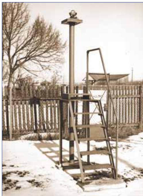
Heliograf w ogródku meteorologicznym we Włodawie, 21 marca 1968
